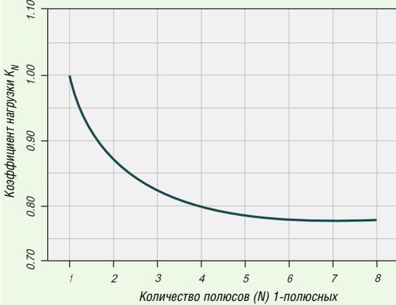
Нагрузочная способность при размещении N автоматических выключателей при изменении температуры окружающей среды
