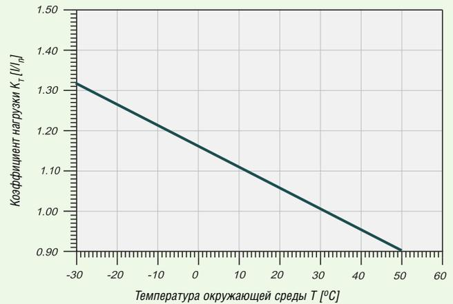
Ток неотключения автоматического выключателя при N автом. выключателях рядом друг с другом и температуре окруж. среды T:  $IDL = I_n \cdot K_T(T) \cdot K_N(N)$ .
