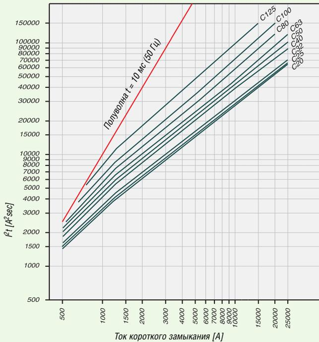
Характеристика I<sup>2</sup>t PLHT, характеристика отключения D, 1-полюсное исполнение
